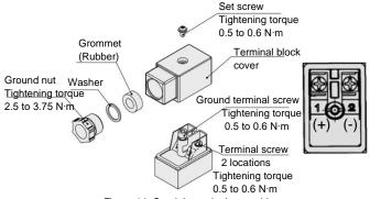
Figure 14. Conduit terminal assembly
