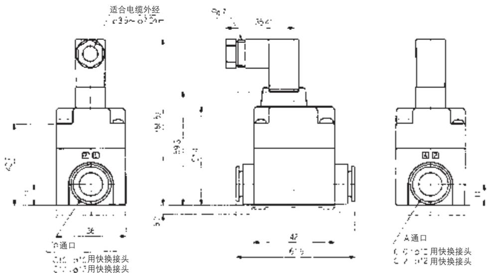
虚线表示托架安装型(-F)。
