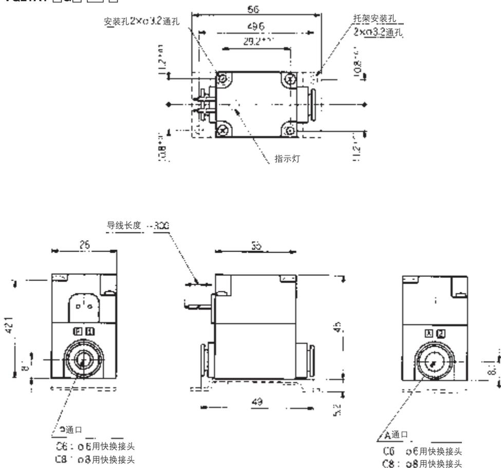
虚线表示托架安装型(-F).
