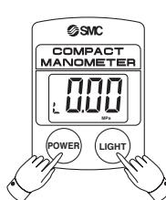
通过锁定模式(消除电源自动OFF)，消除电源自动OFF功能。
