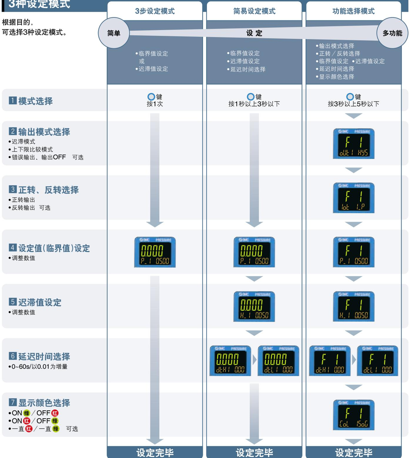
注:上图为OUT1动作示意图。OUT2的场合,功能选择模式下选择“F 2”,上图的“1”全变为“2”。(例)P\_1→P\_2
